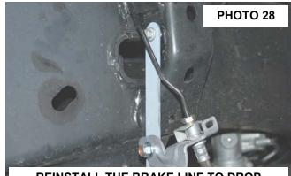
**REINSTALL THE BRAKE LINE TO DROP**
