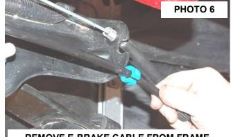
**REMOVE E-BRAKE CABLE FROM FRAME**
