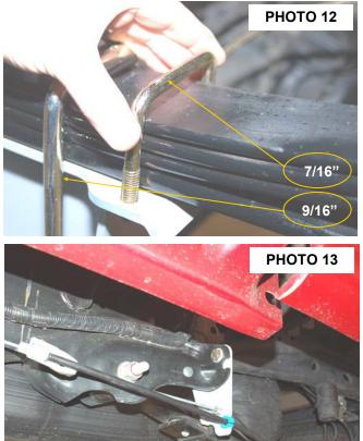
**REINSTALL E-BRAKE CABLES TO BRACKET**
